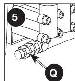
**Sistema de Inyección de Productos Químicos:** Mezcla los limpiadores o solventes con agua para mejorar la eficiencia del lavado.
