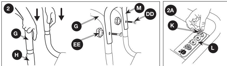
6. Saque las boquillas (K) de conexión rápida de la bolsa plástica e insértelas en las abrazaderas correspondientes en el portaboquillas (L). **NOTA:** Las boquillas están codificadas por colores que coinciden con su abrazadera en el panel.
