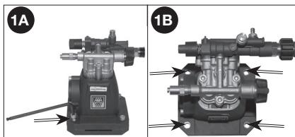
2. Instale la placa de montaje en el motor con una llave tubo de 1/2" para apretar los pernos de cabeza hexagonal y las arandelas de anillo partido suministrados. Apriete los pernos a 15-17 lb/pie. Vea las Figuras 2A y 2B.
